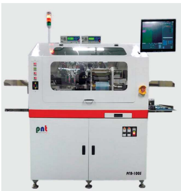
피엔티의 형광체 필름 부착 장비 'PFA-100S'는 형광체와 특허료를 절감하고 수율을 높여 LED 원가를 절감할 수 있다.
