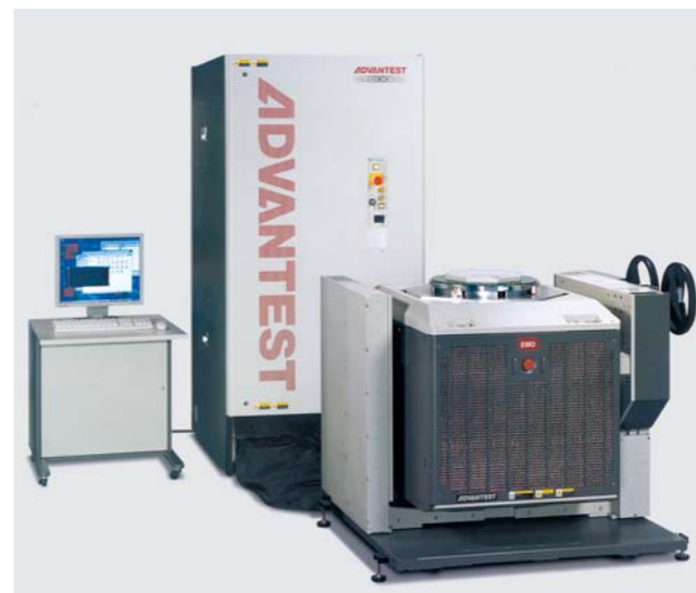
아드반테스트코리아의 'T2000테스터'는 설치되는 모듈만 바꾸면 최초 용도와 다르게 활용할 수 있다.
