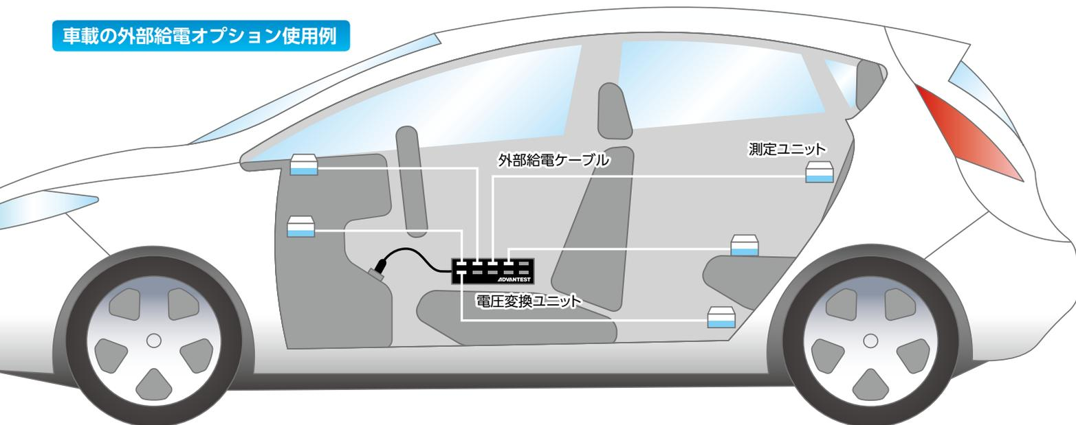
DC電源(8V~24V)に「電圧変換ユニット」を接続し、給電ポートから「外部給電ケーブル」を使い各測定ユニットに電源を供給します。1つの電圧変換ユニットで最大10個\*の測定ユニットに給電が可能です。\*外部給電ケーブルを10本使用
