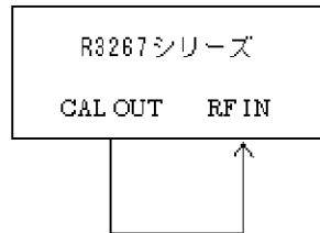
図 6-8 CAL OUT 信号を使ったハードウェアの簡単なチェック
