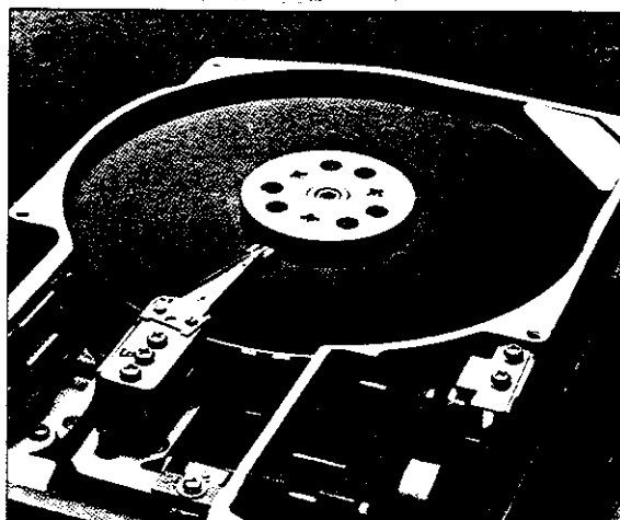
図 4-24 磁気ディスクのスイング・アーム
