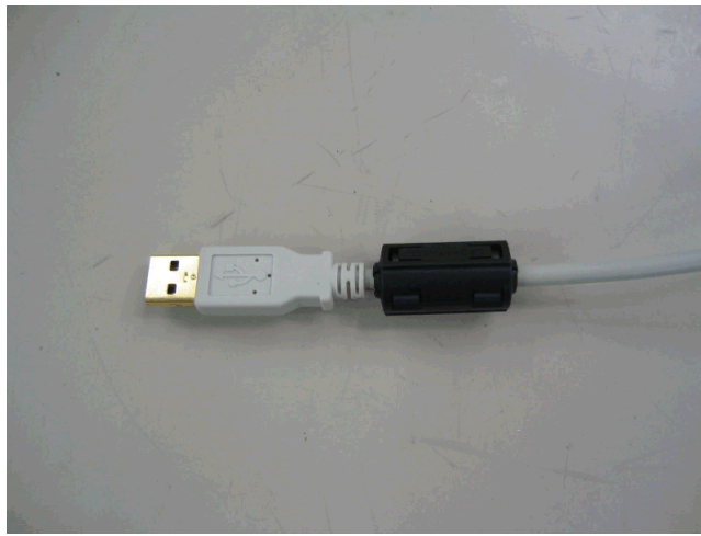
図 3-4 フェライト・コアの取り付け 1
