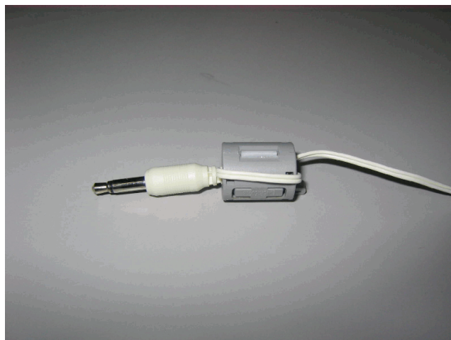
図 3-5 フェライト・コアの取り付け 2
