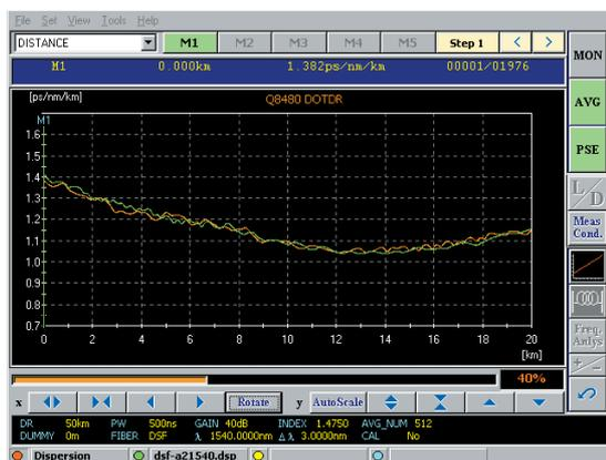
図2 分散測定精度(反転比較表示)
