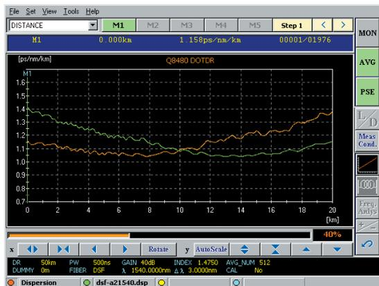
図1 分散測定精度(両方向測定結果)
