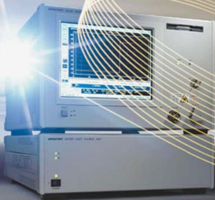
Q8480は、光ファイバにおける距離方向の波長分散分布測定を、広い波長範囲において高速/高精度測定を可能にした光ファイバ分散分布測定器です。
