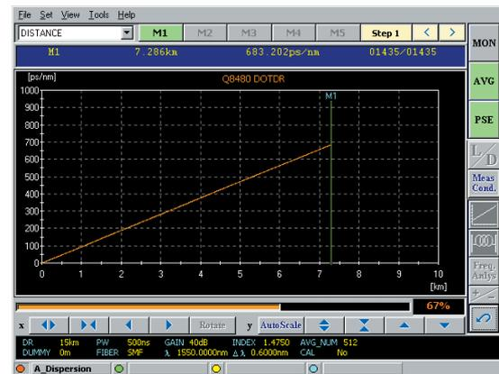
図3 分散補償ファイバの測定例(累積分散表示機能)
