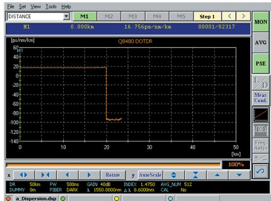
図7 SMF + DCF接続時の分散分布測定例
