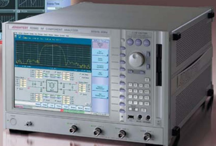
R3860 RFコンポーネント・アナライザは、300kHz～8GHz帯RF部品の性能評価に最適なアナライザです。R3860は、平衡入出力部品やフロントエンド・モジュールなどのマルチポート部品のネットワーク測定機能やミキサなどの周波数変換デバイスの測定機能などを装備し、複合化が進むRF部品の特性を簡単に解析することができます。
